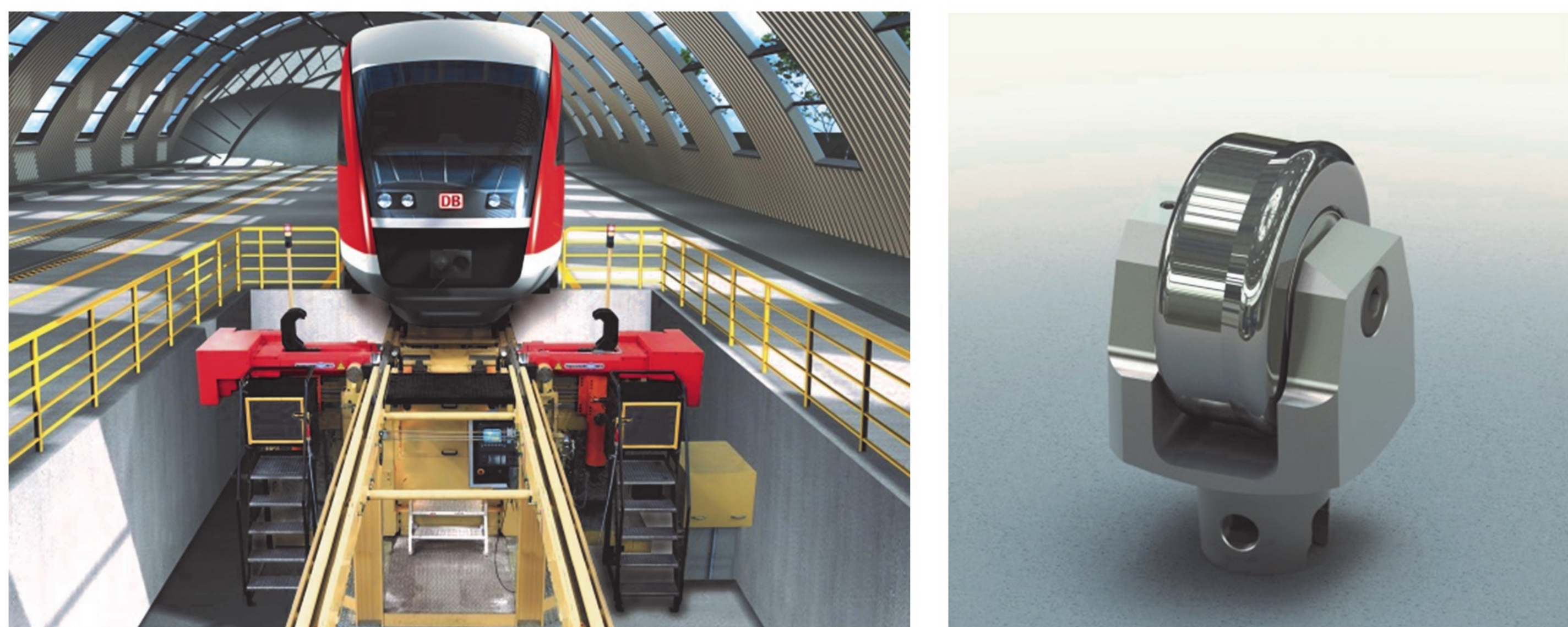
Abbildung 1: Unterflurradsatzdrehmaschine (links) und Walzeinheit (rechts)
