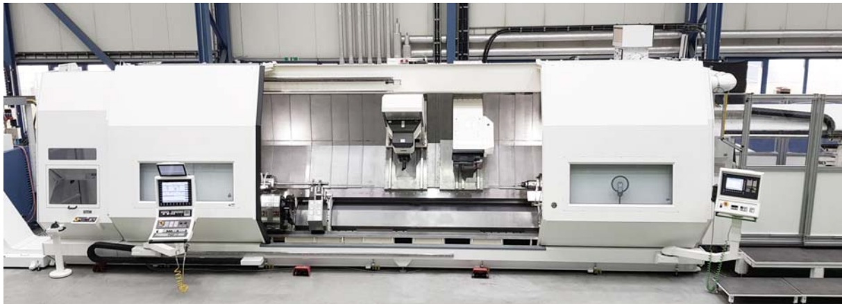
Abbildung 6 – Dreh-Fräs-Zentrum N30 MC inkl. Bohrstangenmagazin und bis zu 32 NC-Achsen
