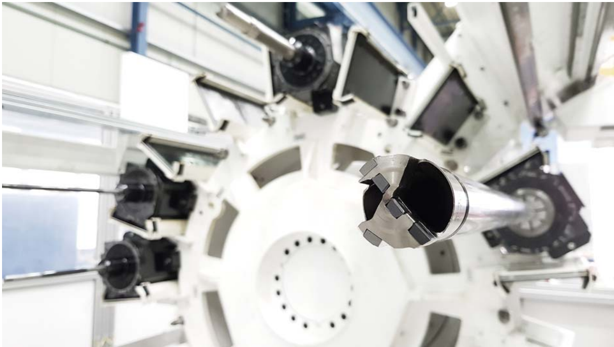
Abbildung 4 – Zusätzliches Bohrstangenmagazin für komplexe Innenbearbeitungen
