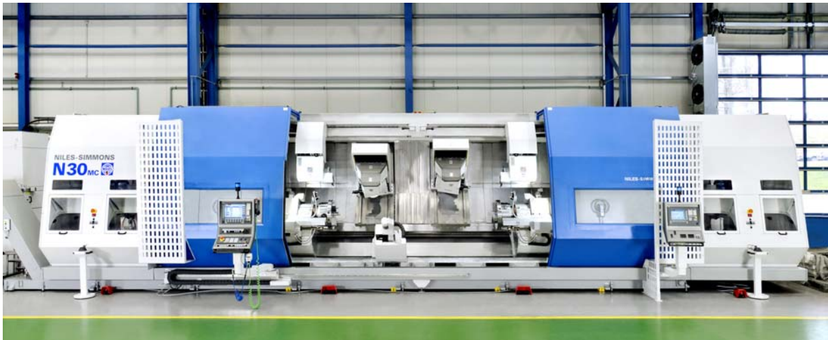
Abbildung 1 - Dreh-Fräs-Zentrum N30 MC mit CLOSED-DOOR-MACHINING Bearbeitungskonzept
