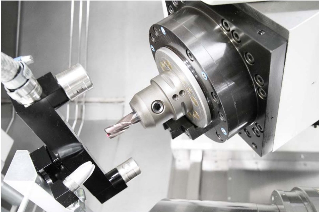
Abbildung 3 – Integrierte Werkzeugvermessung mit Laserbrücke
