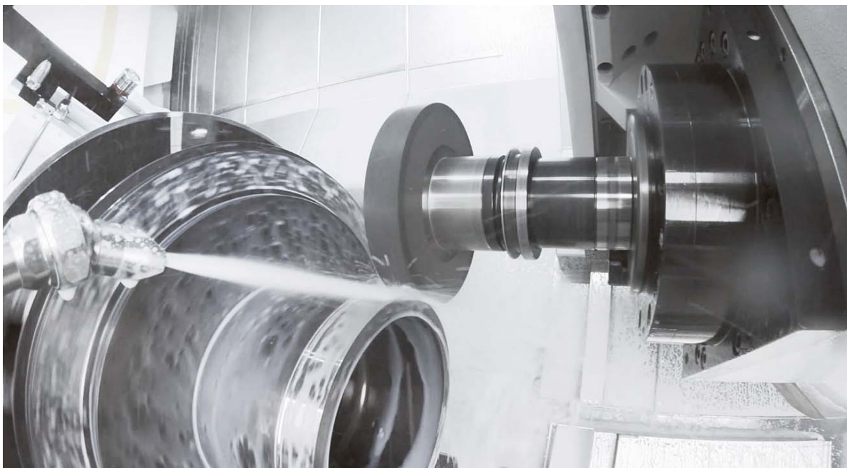
Abbildung 5 – Verfahrensintegration: Schleifen inkl. Abrichteinheit und spezifischer Prozess-Software
