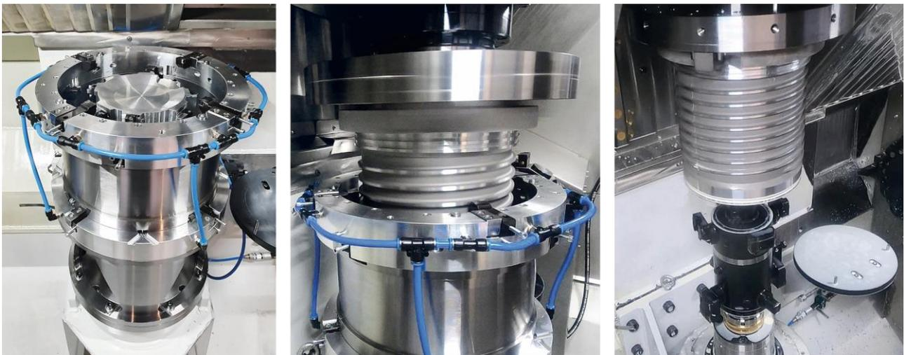
*links: Das Semischlichtwerkzeug für die Innenbearbeitung ist in der unteren Spindel gespannt. Umschlossen wird es vom glockenförmigen Außenwerkzeug, das fest montiert ist; mitte: Bei der simultanen Bearbeitung wird das Werkstück von oben in den Ringspalt zwischen dem Außenwerkzeug und dem Innenwerkzeug gefahren. Bei der Zerspanung wird dabei mit reichlich Kühlschmierstoff gearbeitet; rechts: Die Fertigbearbeitung aller Innendurchmesser erfolgt mittels Feinbohrwerkzeug.*
