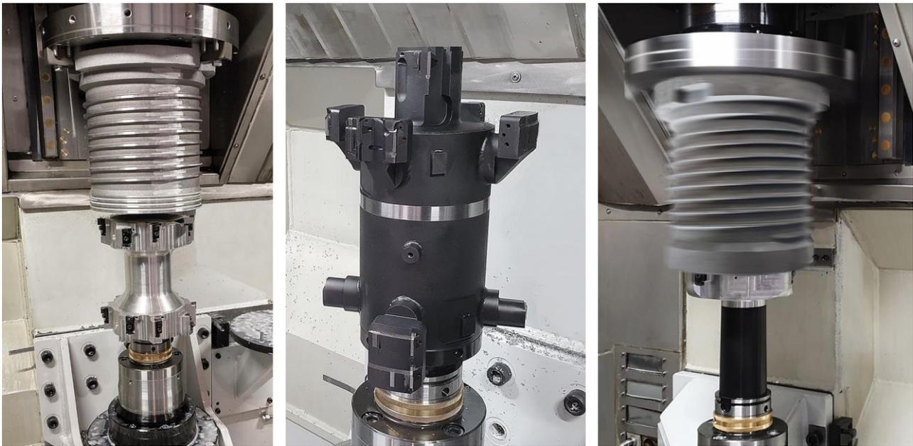
*links & mitte: Das Werkstück ist an der oberen Spindel gespannt und wird in einer Aufspannung nacheinander zu den Bearbeitungsstationen verfahren; rechts: Erster Arbeitsschritt ist das Schruppen der Innenseite des Gehäuses*
