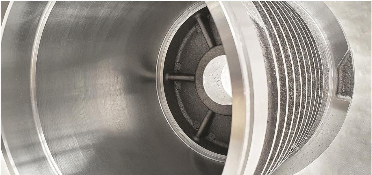
*Die Zerspanung des Statorgehäuses umfasst die Innenbearbeitung mit verschiedenen Absätzen, die Bearbeitung der kleineren Mittenbohrung sowie die Bearbeitung der Außenseite mit ihren Kühlrippen.*
