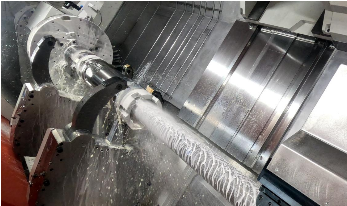
Abbildung 3 – Innenbearbeitung mit Hochdruck-KSS bis 300 bar und mit sensorgestützten Systembohrstangen und Steuerungsintegration über die NILES-SIMMONS-eigene SPS-Schnittstelle
