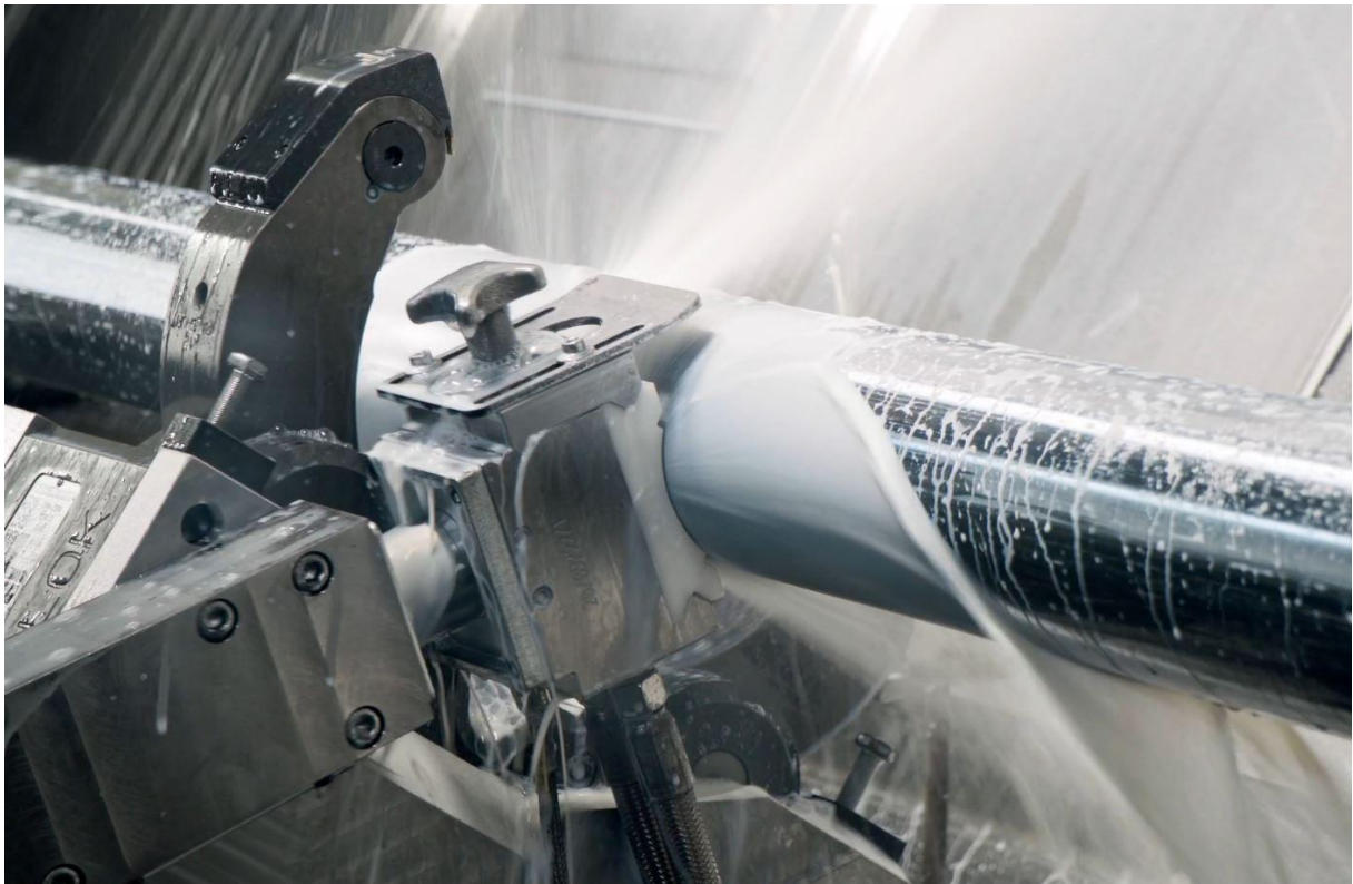
Abbildung 2 – NILES-SIMMONS New Generation TURN-MILL mit hydrostatischer Werkstückabstützung für Exzellenz in der Wellenbearbeitung
